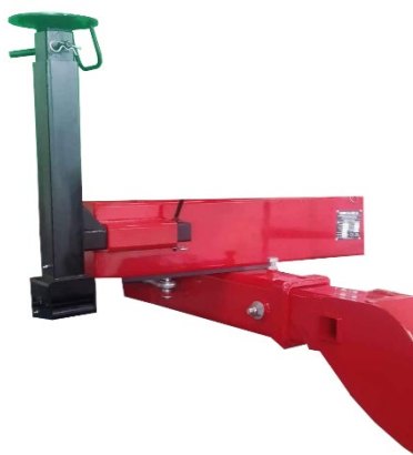
Rysunek 5. Pozycja transportowa wspornika mechanicznego dyszla
